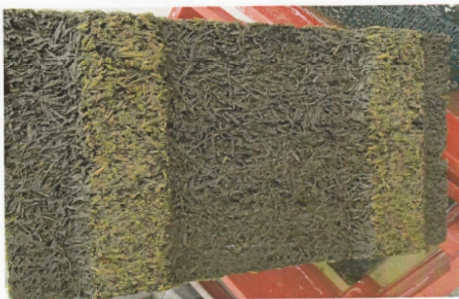
Рис. 2. Внешний вид панели после 220 циклов замораживания-оттаивания по методике 2-го базового метода ГОСТ 10060-2012
