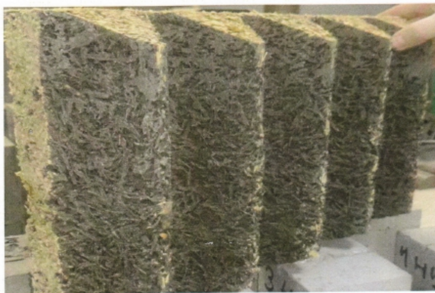
Рис. 2. Внешний вид панели после 160 циклов замораживания-оттаивания по методике 2-го базового метода ГОСТ 10060-2012
